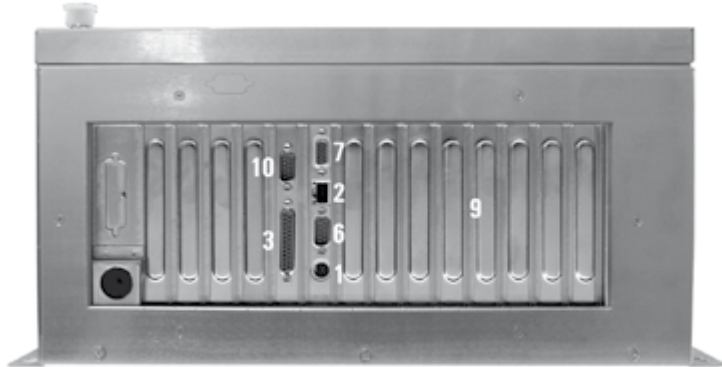
Bild: Anschlussfeld IPC-1514 mit Back- plane (Beispieldar- stellung, abhängig von den verwendeten Hardwarekomponen- ten und Bauteilen)
