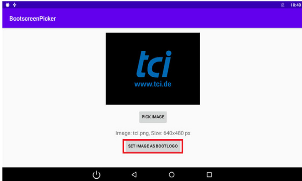
Abb. 15: Klicken Sie auf „Set Image as bootlogo“. Folgen Sie den Anweisungen auf dem Bildschirm, um die Einstellung als Boot Logo zu finalisieren.
